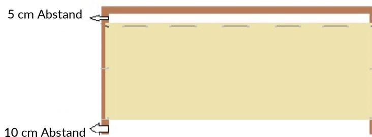
Abb. 1b. Vorgeschlagene Methode für die Montage des Vorhangs (Tunnel für Seil oben, Maschen seitlich)
